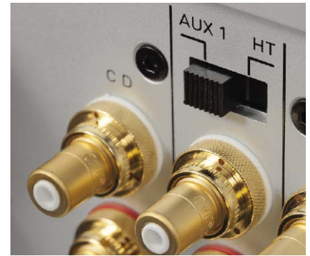
Jedno z gniazd RCA możemy ustawić jako typowe wejście liniowe lub w trybie integracji z systemem wielokanałowym.
